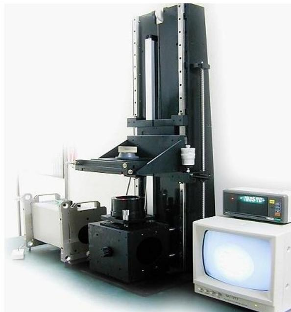
\* 使用元件包括: 轉折五軸組合, 標準鏡頭, 雷射干涉儀, 光學尺
